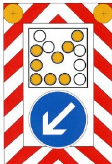
Zeichen 616 (fahrbare Absperrtafel mit Blinkpfeil) [kleine Ausführung]
